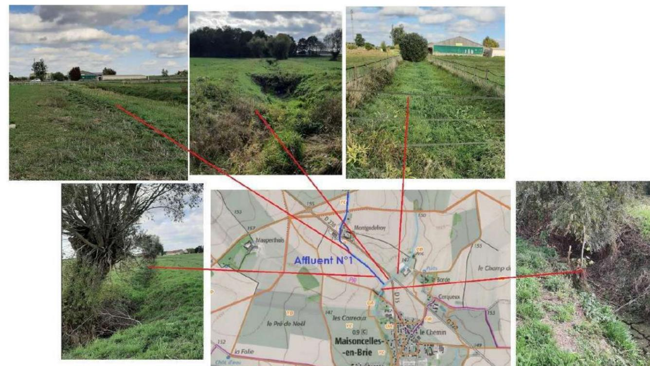
Sur sa partie aval, section sur laquelle s'inscrit l'aménagement ZRT4, le ru de la Fosse aux Coqs est assez encaissé, mesurant jusqu'à 2 mètres de profondeur. Le fond du ru est en terre avec une largeur de 1m à 1,5 m. Les berges sont constituées d'une ripisylve alterne et fragmentée, toutefois plus dense que le tronçon amont. La largeur en hauts de berges est de 3,5 m à 4m environ.
