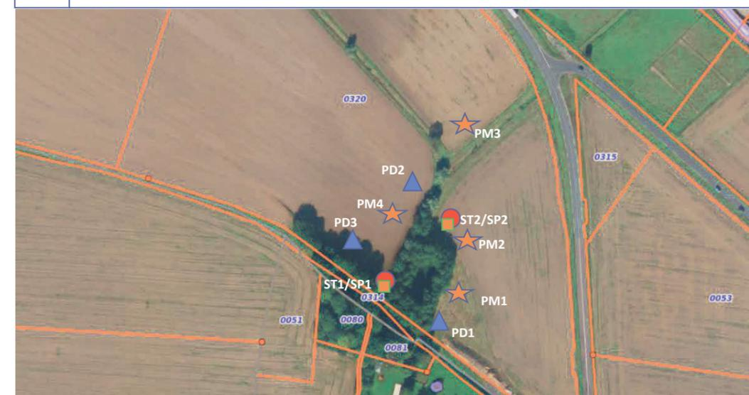
Figure 13. Plan d'implantation des forages et sondages.
