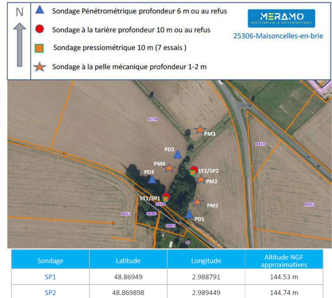
Ces sondages réalisés en date du 13/03/2025, ont intercepté des niveaux d'eau entre 0,50 et 1,40 m de profondeur.
