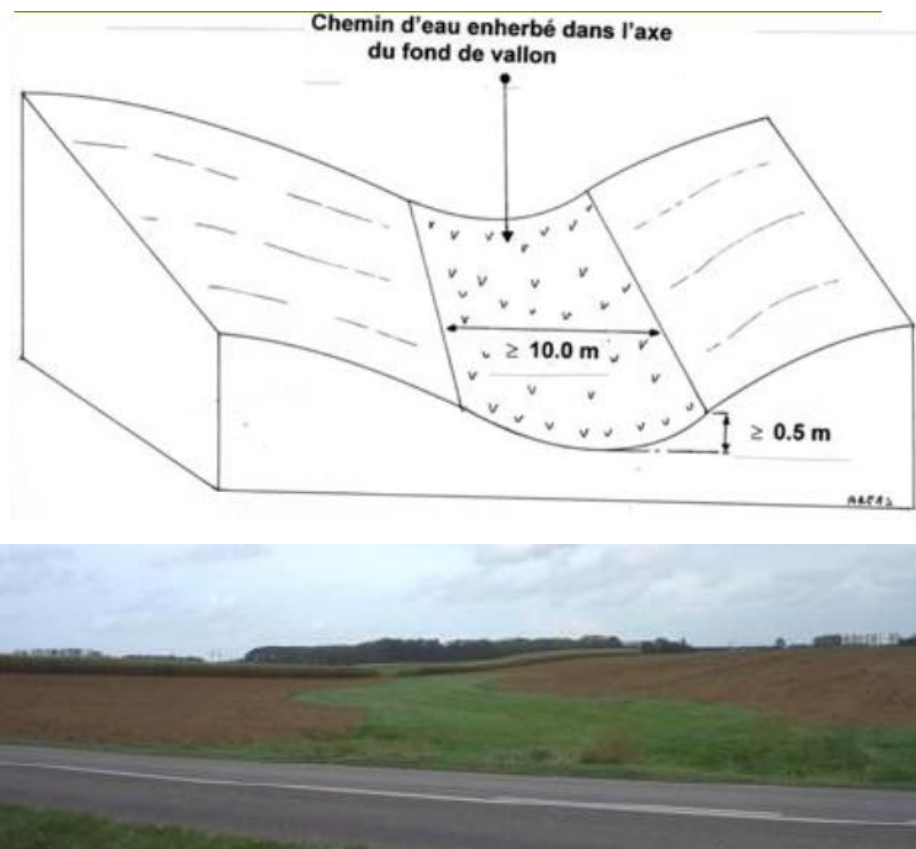
Figure 11 : Schéma explicatif et exemple de chenal enherbé (source : AREAS)
