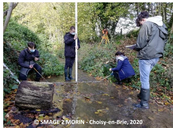
Figure 13 : Réalisation de relevé topographique
